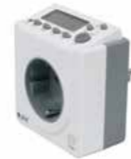
SJD-CP16 디지털타이머스위치 4A 디지털, 콘센트플러그일체형 AC 220V 16A 60Hz 최소설정단위 1분 초기설정오차 없음 구동시간오차 최대 ± 2초/일 최소정전보상시간 6개월
