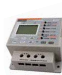
SJD-K25A 일출일몰타이머스위치 일출일몰시간내장형 AC 220V 60Hz 저항부하 25A / 유도성부하 8A 최소설정단위 1분 구동시간오차 최대 ± 2초/일 최소정전보상시간 6년
