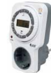
SJD-C16 디지털타이머스위치 4A 디지털, 콘센트형 AC 220V 16A 60Hz 최소설정단위 1분 구동시간오차 최대 ± 2초/일 최소정전보상시간 6개월
