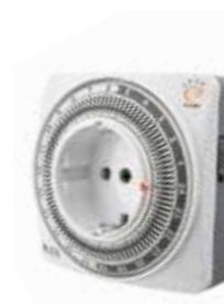
SJP-CP16 기계식타이머스위치 4A 일반용, 콘센트플러그일체형 AC 220V 16A 60Hz 최소설정단위 15분/핀 초기설정오차 최대 ± 15분 구동시간오차 AC주파수와 동일
